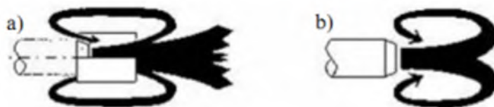
图 8.2-3 烟气内循环示意图 (a.再循环罩, b.射流卷吸)
